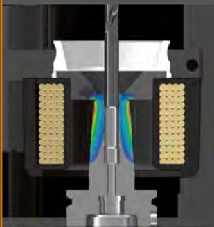
**Vorteil Induktionstechnik** – ThermoGrip®, das modulare Schrumpfsystem mit perfekter Abstimmung zwischen Aufnahme und Schrumpfgerät.
